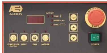
Tableau de commandes à touches digitales. Les All In Sealer D 552 sont équipées d'un mode de refroidissement automatique. Si la machine doit être arrêtée et que la température de soudure est supérieure à 80°, la machine refroidira jusqu'à ce que la température retombe au-dessous de 80° puis la machine s'arrêtera automatiquement en mode standby. Ces fonctions permettent de préserver les bandes téflonnées durant les procédures d'arrêt.
